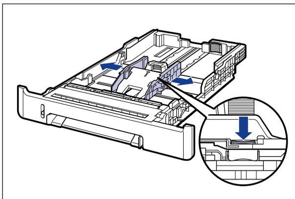
**3** 抓住后纸张导板的锁定释放杆的同时，滑动纸张导板。
