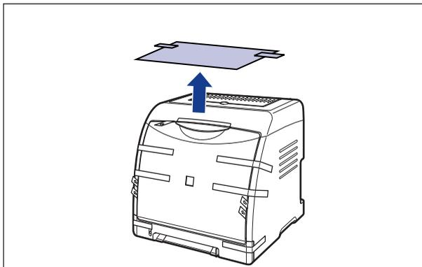
**4** 取下粘附在打印机上的胶带（6 处）。
