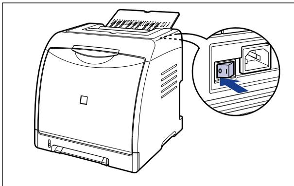
**2** 将提供的电源线插入到电源插孔中。
