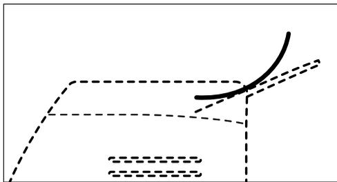
当输出到出纸托盘的纸张出现下图所示的卷曲时指定 [ 背面校正 ( 加卷曲效果 ) ]。
