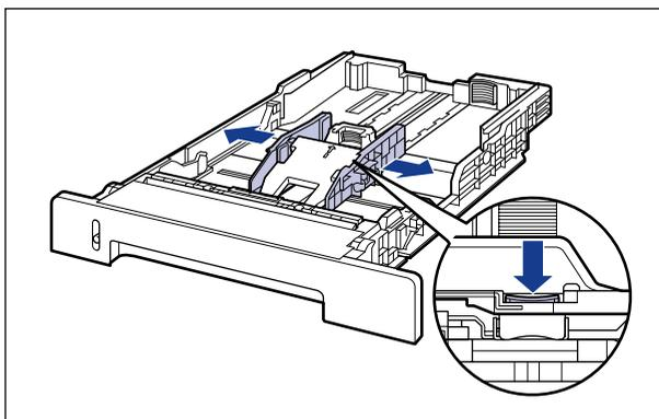
**4** 抓住后纸张导板的锁定释放杆的同时，滑动纸张导板。
