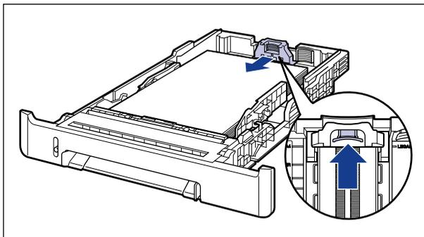
**6** 按下纸张（如下图所示），确保纸叠没有超过装纸限制标记（A），然后将其设置为在纸张导板挂钩（B）的下面。
