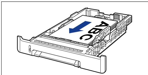
**4** 在按住两侧纸张导板的锁定释放杆的同时，将导板滑到装入的纸张尺寸标记。
