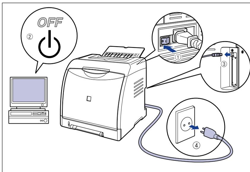
**2** 拔下打印机上的所有接口电缆和电源线。
