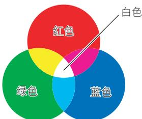
不过，彩色打印机再现颜色时使用的不是光线的 3 原色，而是绘画中所使用的 3 原色。如果将绘画的 3 原色（C（青色）、M（品红色）和 Y（黄色））相混合，得到的将是黑色（减色混合法）。
