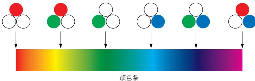
就打印机而言，无法更改墨粉颜色的浓度。因此，较之计算机显示屏而言，打印机上使用的点阵数量要多得多，它将 K（黑色）添加到 C（青色）、M（品红色）和 Y（黄色）中来再现各种颜色。这意味着点阵越小，彩色打印的分辨率就越高。
