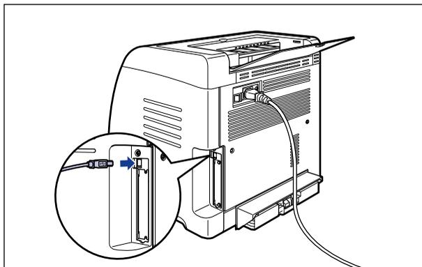
**3** 将 USB 电缆的 A 类（扁平状）端连接到计算机上的 USB 端口。
