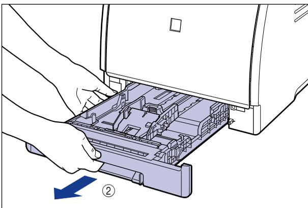
**2** 抓住两侧纸张导板的锁定释放杆的同时，滑动纸张导板。
