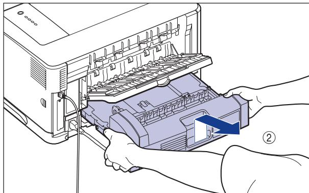
□ 微微抬起子出纸托盘 ①，然后使黑色传输导板的挂钩松脱 ②。
