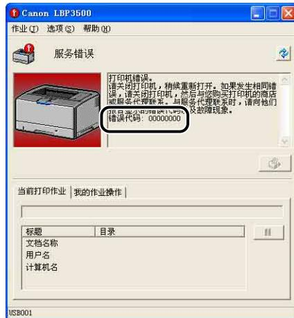
**3** 关闭打印机和计算机 ①，拔下 USB 电缆 ②，然后从 AC 电源插座上拔下电源插头 ③。
