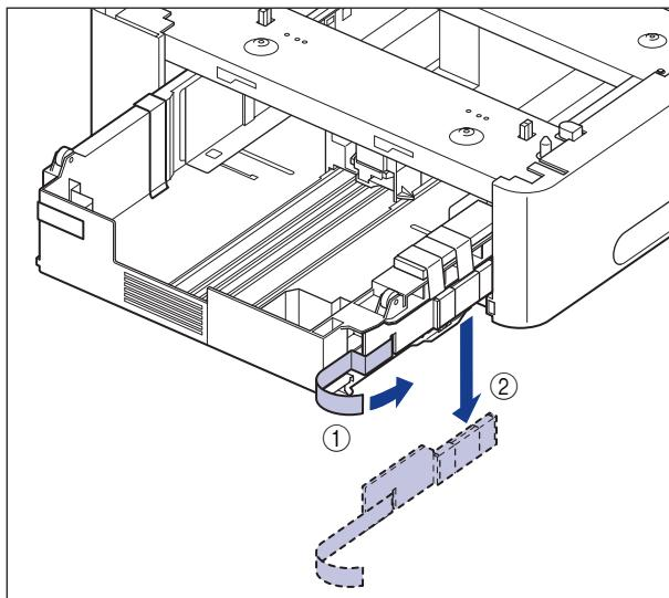
撕下如图所示的两条胶带①，然后拆除包装材料②。
