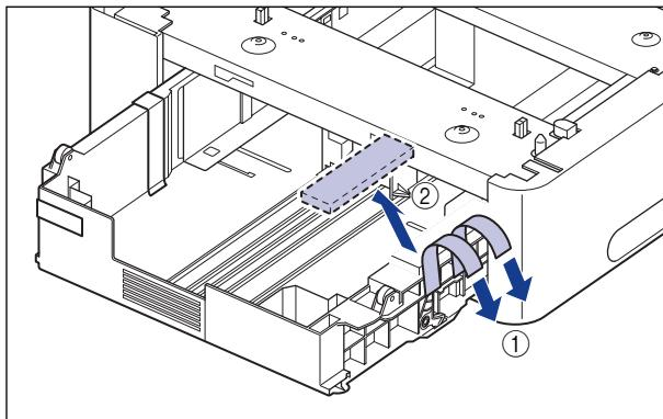
撕下如图所示的两条胶带 ①，然后拆除带有胶带的包装材料 ②。
