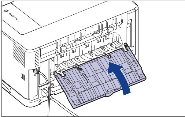
□ 按图中所示方法握住双面组件，并将其水平稳固推入打印机。
