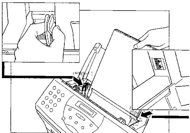
确认纸没有超过供纸器右边的纸限制标记。
