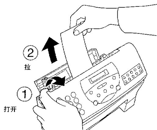
也请取下供纸托盘及供纸托盘盖的包装材料。
