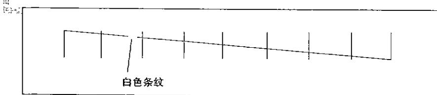
假如打印输出出现上面所示的白色条纹时，请清洗打印头。
