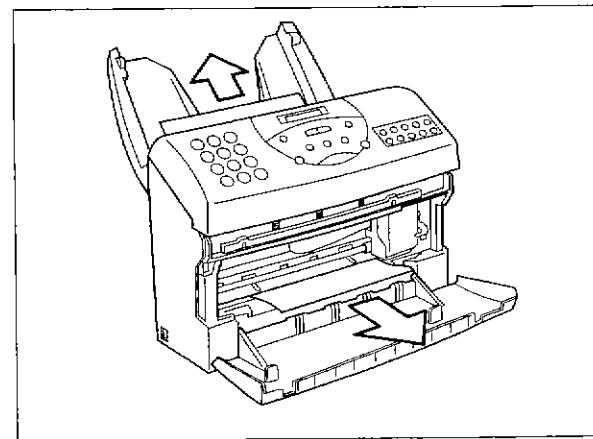
**6** 装填好纸（参阅装载纸张P.7），然后重新放好供纸托盘盖并按〔停止〕键。
