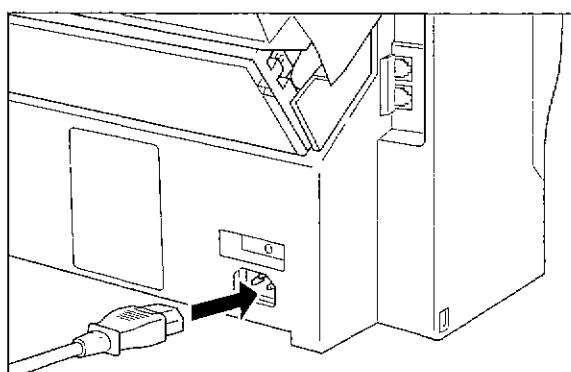
**2** 将电源线的另一端插入带有地线的电源插座中。
