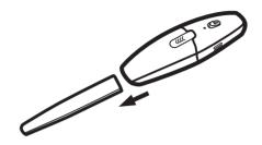
3、按住装置按键的同时,把前壳向下旋转从机体上取下(当清理污物时,取下的前壳应将其头部朝下,以免灰尘倒出;并且安装前壳时, 先将下部的扣位与机体对准,然后向上旋转通过装置按键与机体装配好)。
