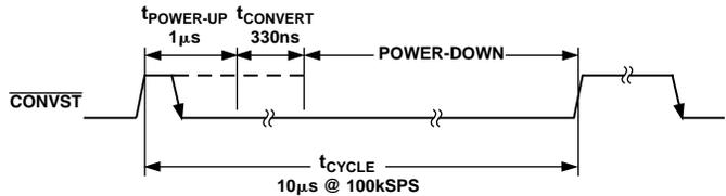
Figure 10. Automatic Power-Down
