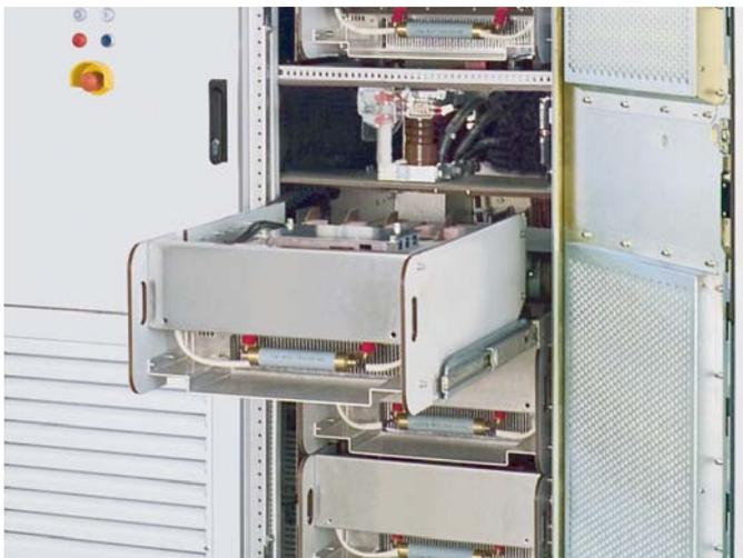
ACS 2000变频器可以实现正常运行时间最大化，同时为快速维护提供便利。模块化设计本身有助于快速、高效地更换部件，平均维修时间(MTTR)居于业界领先水平。
