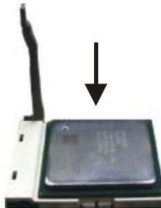
5. CPU 完全置入插座後，將拉桿向下推回，並卡入插座側邊的卡榫中，以確定 CPU 已牢固地安裝於插座中。
