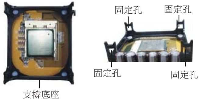
2. 將附有風扇/散熱片的組裝支架放置在處理器上方，再將組裝支架四隻腳上的掛勾扣入支撐底座四個角落的固定孔。
