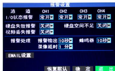
**I/O 状态报警：**每个通道对应一个 I/O 状态报警，即当某路报警输入有效时启动对应通道的报警录像。
