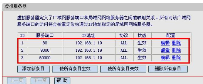
点击“添加新条目”，把 DVR 的 IP、端口（WEB 端口，媒体端口，手机端口）填入相应的位置，协议为 ALL，状态为生效或启用。再点击保存，用同样的方法添加另外几个端口。其中 60000 为手机监控端口，要做使用手机监控功能的话必须得添加此端口。如上图所示，9000，80，60000 端口均可以在 DVR 主菜单里修改。
