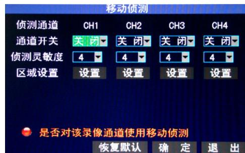
**通道开关：**每个通道有对应的通道开关，按“确认”可以选择开启或关闭移动侦测
