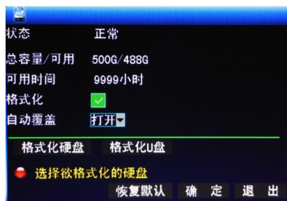
**硬盘状态：**在硬盘连接后，系统会自动检测硬盘是否正确，如果硬盘需要进行格式化的话，会在硬盘状态上显示“未格式化”，此时可点击“格式化硬盘”对硬盘进行格式化。如果系统检测到可使用的硬盘时，硬盘状态会显示“正常”。
