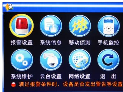
高级功能包括报警设置，系统信息，移动侦测，手机监控，系统维护，云台设置和网络设置七项内容。
