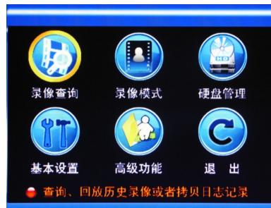
**注：**对以下所有子菜单的设置，都必须在按“确认”之后才能生效，直接退出本页设置无效。将光标移动到任意选项时，界面下方会自动显示该选项的注释提示信息。
