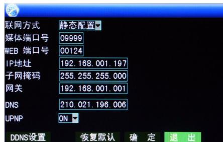
**联网方式:** 有三种联网方式可供选择：静态配置，DHCP 和 PPPOE
