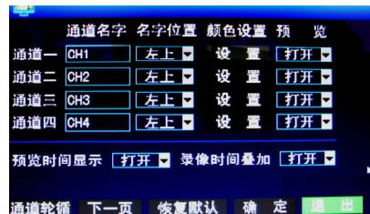
**通道名字:** 移动光标到该项的输入框，按“确认”键进入此项输入界面，支持数字、英文、中文拼音输入法；
