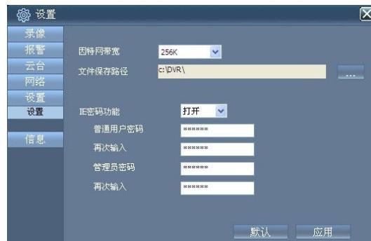
**因特网带宽:** 设置码流大小, 码流越大, 远程图像越清晰, 但要求网络带宽较高, 否则图像效果会比较延时。
