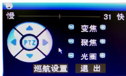
此界面可以控制云台转速（快、慢）、方向、镜头变焦、聚焦、光圈、巡航设置。
