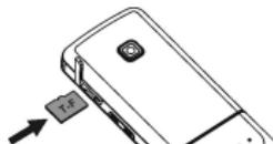
当您需要取出存储卡时，请打开卡塞，向内轻按存储卡使其解锁，再取出存储卡。
