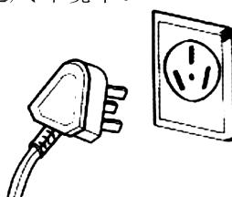
9. 由于微波炉工作电流大，插座应专用，不要同其它电器共用（特别是电冰箱类）否则容易造成电路过载，损坏电器。
