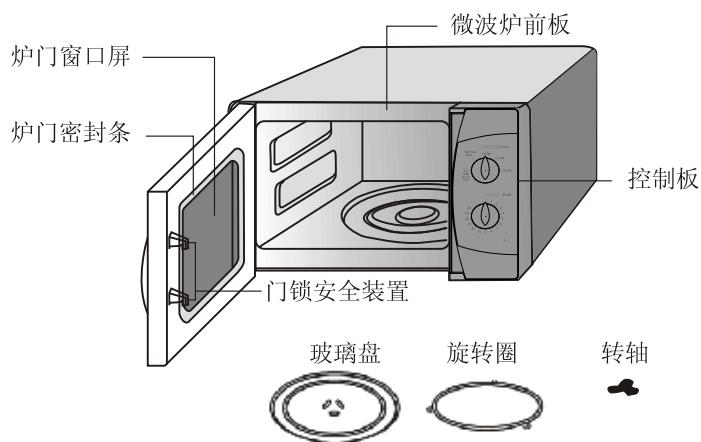
将您的微波炉和所有的部件从包装箱中取出
