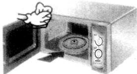
3. 必须保持微波炉门与炉体接触面的清洁。
