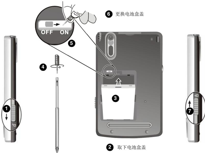
**要点：**除非需要恢复出厂默认设置（冷启动），否则请将开关设置保持在 ON（右侧位置）。执行冷启动（将电池开关设置到 Off（关闭），然后再设置到 On（打开））将会删除所有存储在 SDRAM 内存中的文件。请参阅第 68 页的“恢复出厂默认设置（冷启动）”获取更多信息。
