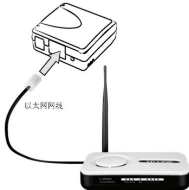
3. 将电源适配器与打印服务器连接起来并上电，若 LINK LED 指示灯亮，则说明打印服务器已成功连接到您的局域网。
