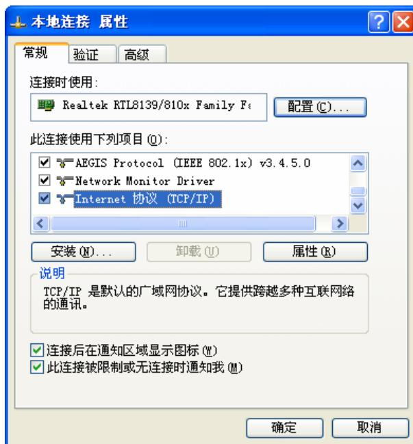
2. 双击“Internet 协议”（TCP/IP），出现如下图所示页面。如果您希望拥有固定的 IP 地址，请选择使用下面的 **IP 地址** 和使用下面的 **DNS 服务器地址**，然后手动设置网络参数，其中 IP 地址为 192.168.1.2—192.168.1.254 范围内的任意值，参数设置可以参照下图设置：
