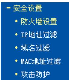
在“安全设置”菜单下面，共有“防火墙设置”、“IP 地址过滤”、“域名过滤”、“MAC 地址过滤”和“攻击防护”五个子项。单击某个子项，即可进行相应的功能设置，下面将详细讲解各子项的功能。
