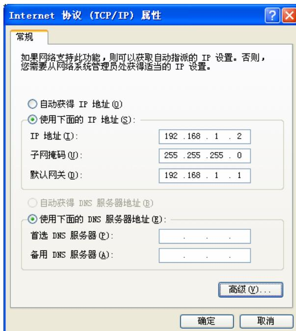
3. 如果您希望自动从路由器获得 IP 地址，请选择自动获得 IP 地址和自动获得 DNS 服务器地址，点击确定后设置将生效。
