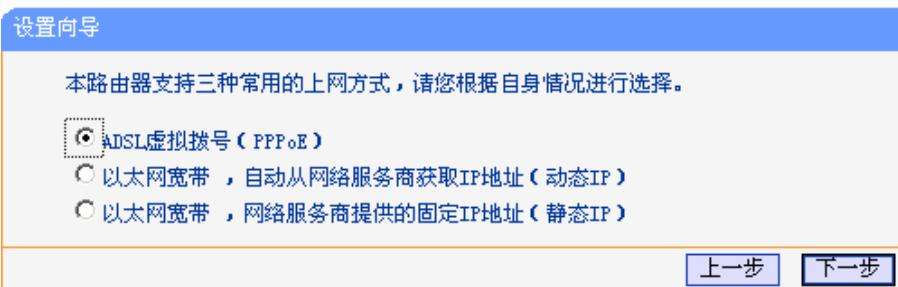
以上画面显示了最常用的三种上网方式，可以根据自身情况进行选择，然后单击“下一步”填写上网所需的基本网络参数。
