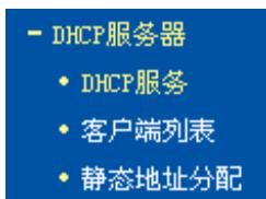
DHCP 服务器主要用来自动配置和管理网络内部主机的 TCP/IP 参数。在“DHCP 服务器”菜单下面，有“DHCP 服务”、“客户端列表”和“静态地址分配”三个子项。单击某个子项，即可进行相应功能设置，下面将详细讲解各子项的功能。
