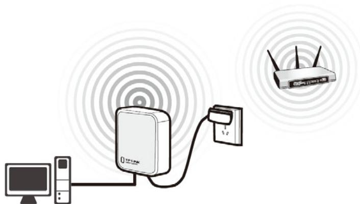
图 4-5 Client 模式连接图
