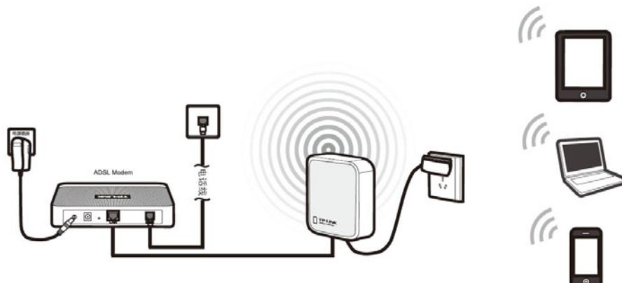
图 4-2 Router 模式连接图
