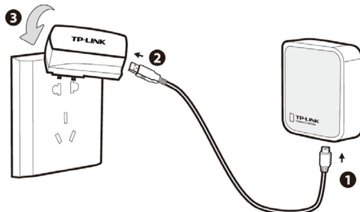
图 4-6 TL-WR702N 硬件安装示意图
