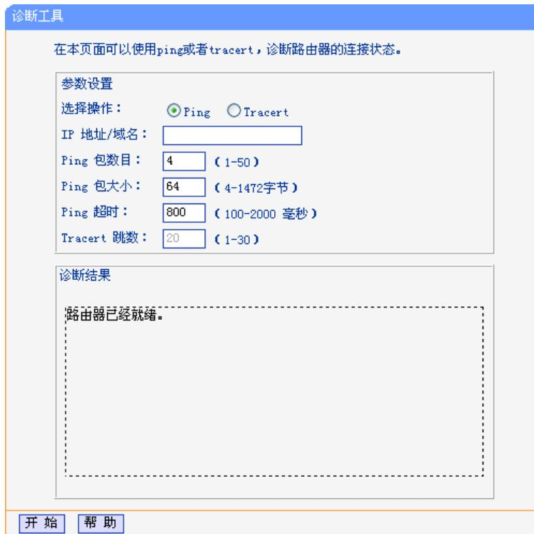
图 8-11 诊断工具
