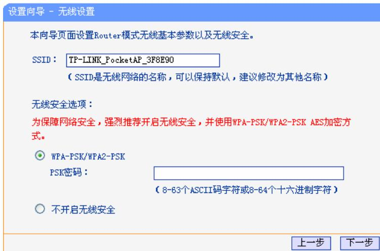
图 4-11 设置向导-Router 模式无线设置
