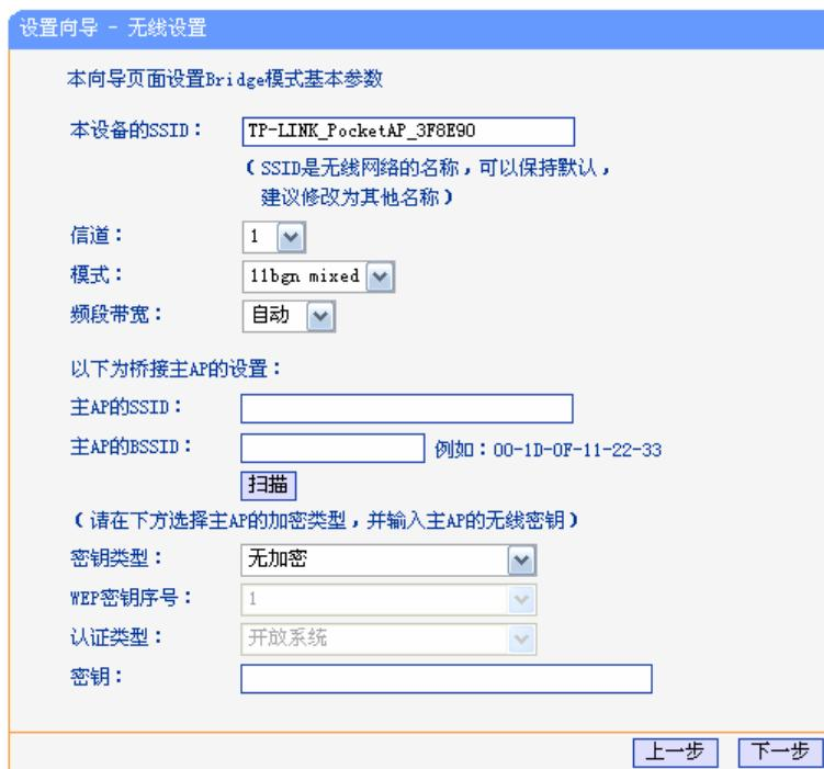
图 4-17 设置向导-Bridge 模式无线设置
