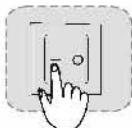
在开机状态下按下遥控器上的待机键，电视机进入待机状态，电视机上的指示灯变红；在待机状态下按下遥控器上的待机键或主机按键上的节目增减键，电视机进入开机状态。
