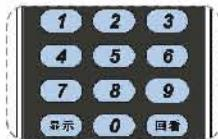
按下遥控器上的数字键即可直接选择频道（默认一位输入方式，按“**0**”键可临时切换到两位输入方式）
