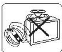
电视机应远离话筒、电动机、变压器等感性物品，以防引起色彩异常。
