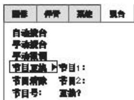
按“菜单”键4次，进入“搜台”菜单，按“节目”键选择“节目互换”项，用“音量”键选择节目1并按“0~9数字选台键”或节目键改变台号，按“音量”键下移光标，选择“节目2”项，用“0~9数字选台键”或节目键改变台号。确定互换的台号后，按“音量”键选择“互换？”项，再按“节目”键互换。按“显示”键退出菜单。
