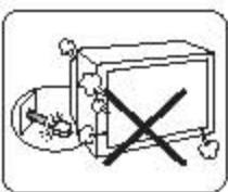
电视机使用中发现异常(如有异味等)或不慎将异物落入机内，应立即关闭电视机并拔出插头，尽快与维修单位联系检修。
