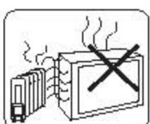
机内温度过高易引起电视机损坏，应保证电视机通风良好，勿堵塞电视机散热孔。电视机应远离壁炉(如：暖气、火炉等)先，并避免阳光直射。
