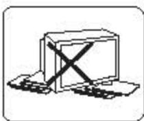
应根据电视机的重量将其放至于有足够的支撑物上，并要安装稳定，以免电视机受到跌落等冲击而损坏。
