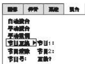
按“菜单”键4次，进入“搜台”菜单，按“节目”键选择“节目互换”项，用“音量”键选择节目1并按“0~9数字选台键”或节目键改变台号，按“音量增”键下移光标，选择“节目2”项，用“0~9数字选台键”或节目键改变台号。确定互换的台号后，按“音量”键选择“互换？”项，再按“节目”键互换。按“显示”键退出菜单。
