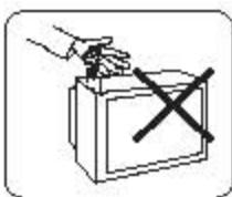
勿将导磁物(如：铁屑、硬币等)放入机内，以防引起电器短路着火，损坏电视。
