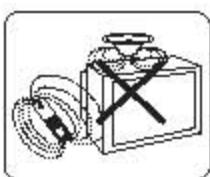
电视机应远离扬声器、电视机、变压器等感性物品，以防引起颜色异常。
