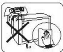
勿用酒精、氯水、煤油等液体清洗电视机表面，若确有需要，请用湿润的柔软布(可加少量中性洗涤剂)擦干后擦拭，并切记在擦拭前切断电源。
