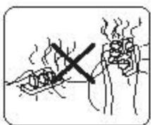
应根据电视机的电源消耗功率选择合适的电源插座，勿与其它电器共用插座。
