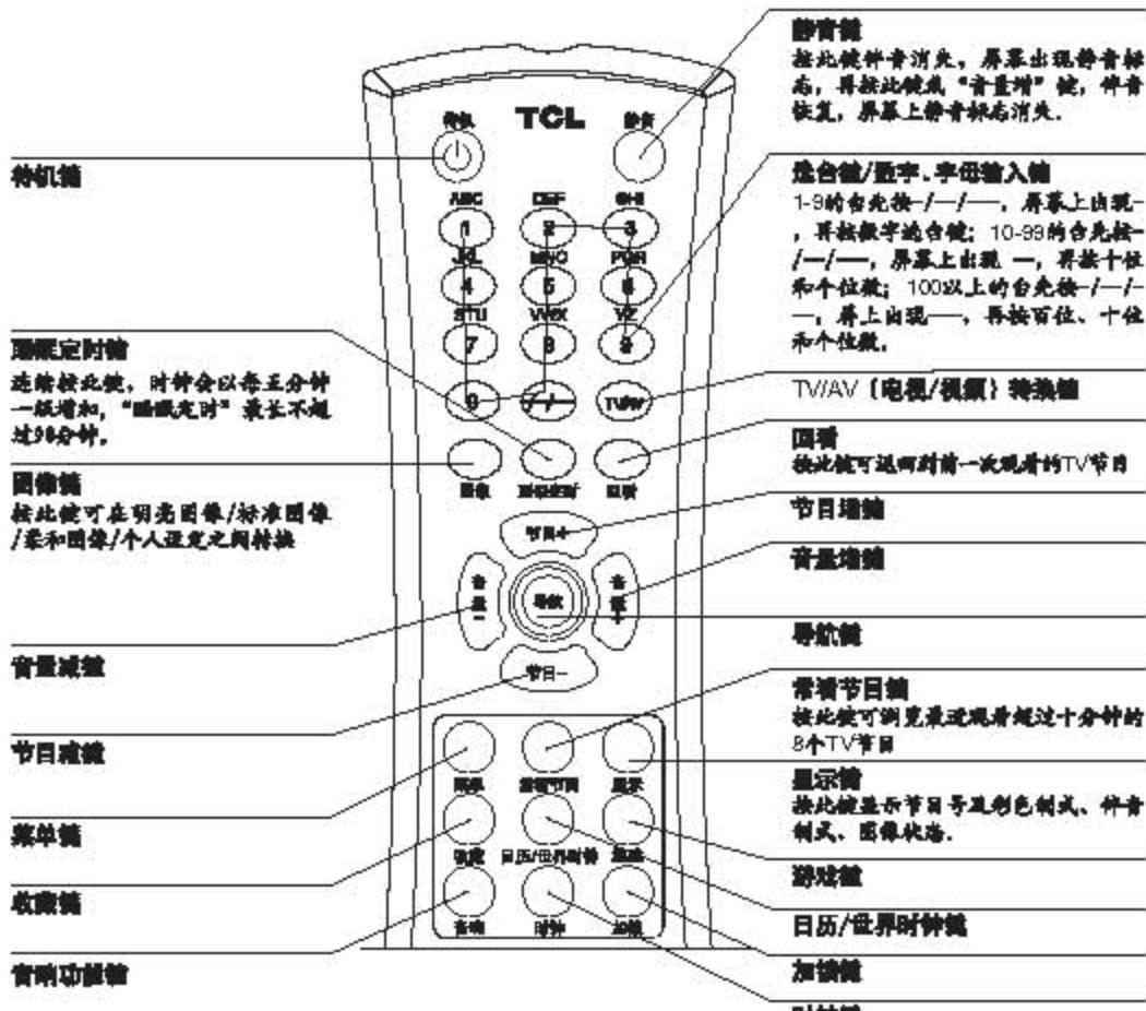
**备注：**遥控器上的“音量+”、“音量-”、“节目+”、“节目-”功能与前壳上的“音量+”、“音量-”、“节目+”、“节目-”相同。
