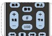
按下遥控器上的节目增减键即可切换频道（音量的增减请按音量增减键）
