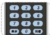
按下遥控器上的数字键即可直接选择频道（默认三位输入方式）
