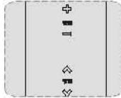
触摸电视机上的节目增减键也可切换频道（音量的增减请按音量增减键）
