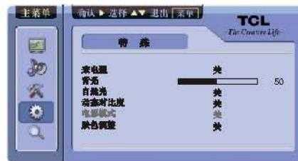
注：来电通功能即信源信号自动检测或转接功能，包括关、来电显示和来电转接三个状态。来电显示开时，用户连接新的信号，电视自动检测并提示用户；来电转接开时，用户连接新的信号输入，电视自动检测信号并转入该信源。来电通设置为来电显示或来电转接，除TV、USB、ITV、PC Link信源外，其他未接入信号的信源不可选。
