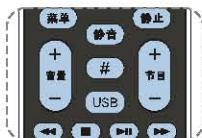
按下遥控器上的节目增减键即可切换频道（音量的增减
