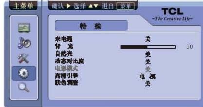
注：来电通功能即信源信号自动检测或转接功能，包括关、来电转接和来电显示三个状态。来电转接开时，用户连接新的信号输入，电视自动检测信号并转入该信源；来电显示开时，用户连接新的信号，电视自动检测并提示用户。来电通设置为来电显示或来电转接，除TV和USB信源外，其他未接入信号的信源不可选。
