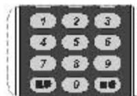
按下遥控器上的数字键和可直接选择键（默认三位数输入方式）
