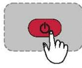
在开机状态下按下遥控器上的待机键，电视机进入待机状态；在待机状态下按下遥控器上的待机键或主机节目源键，电视机进入开机状态。
