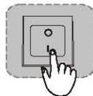
按下电视机上的电源开关上的“0”键，打开电视机。“0”代表断开电源，“1”代表接通电源。
