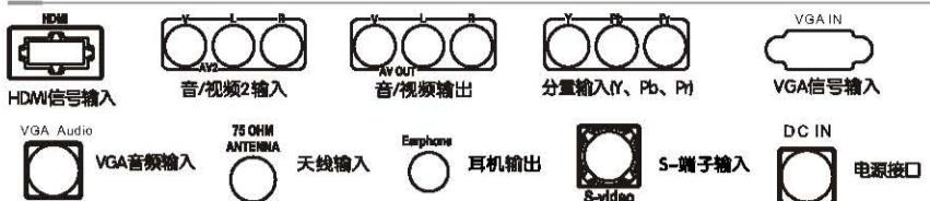
备注：1、视频1输入与S-端子输入共用音频输入端口，故二者不能同时使用。
