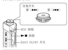
1 关闭收音机。 往 RADIO OFF 方向滑动 RADIO ON/OFF
