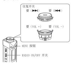
**1** 设置 RADIO ON/OFF 开关为 RADIO ON 打开收音机。
