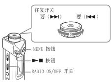
1 关闭收音机。 往 RADIO OFF 方向滑动 RADIO ON/OFF 开 关。
