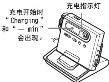
此时，剩余充电时间将显示在显示屏上。将录音机放到 USB 支座一个小时候，充电指示灯将熄灭。此时，电池大约充满了 80% 的电量。再过 3 小时后，电池将完全充满电。
