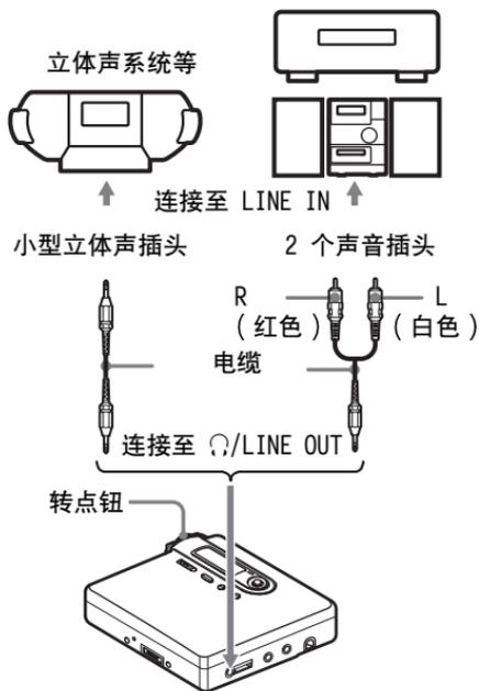
在将线缆连接至录音机的  $\Omega$ /LINE OUT 插孔时，请务必设置  $\Omega$ /LINE OUT 插孔的“AUDIO OUT”参数。
