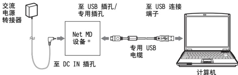
\* 如果您的 Net MD 附带有支架，请将专用 USB 电缆连接到 USB 支架，然后将 Net MD 放到 USB 支架上。
