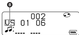
每次转动转点钮时，**A** 会发生变化。在您按下转点钮时，**B** 会显示在显示屏上。
