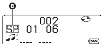
每次转动转点钮时，**A** 会发生变化。在您按转点钮时，**B** 会显示在显示屏上。
