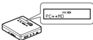
如果连接已正确完成，则 Net MD 的显示屏上将出现“PC→MD”\*。
