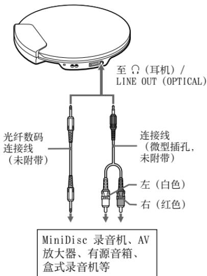
需要在“选项”菜单中更改“音频输出”设置以便声音输出到连接的设备。“音频输出”设置如下所示。要进行设置，请参阅 第 26、28 页。
