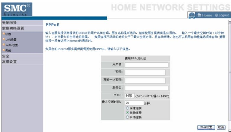
在相应地方输入您的 ISP 提供的用户名和密码。如果您的 ISP 还给您提供了一个服务名，在“服务名”中输入，否则，保持其空白。不要去改变 MTU（最大传输单位）的默认数值，除非你有特定的需求。输入一个最大空闲时间（以分钟计），当超过这个时间，路由器将自动断开与 Internet 的连接。勾选“自动连接”项使您有上网需求时，宽带路由器会自动重建连接。
