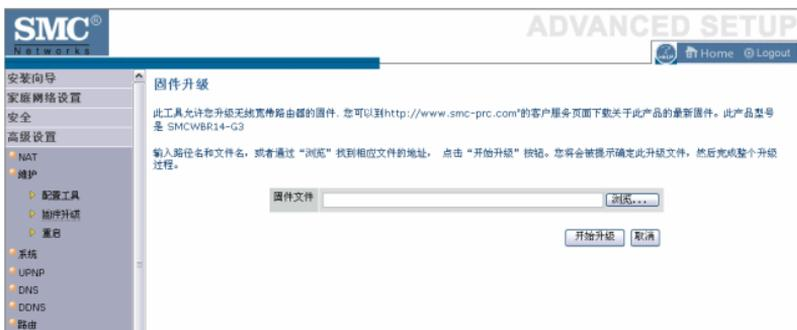
在这个界面中，升级无线宽带路由器的固件或用户界面到最新版本。从 SMC 的中文官方网址 [www.smc-prc.com](http://www.smc-prc.com) 上下载最新的固件，并保存到您的硬盘。在“固件文件”，点击“浏览”选定所下载的文件，点击“开始升级”。是否升级成功可以从状态页的信息栏确定。
