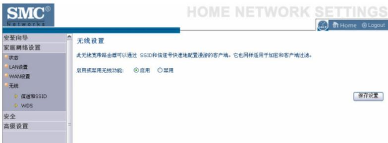
要启用无线功能，请勾选“启用”单选框，并点击“保存设置”。此时，将自动转向到“信道和 SSID”页面。
