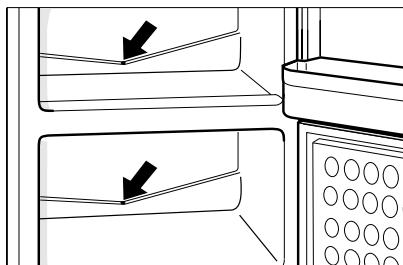
冷藏室和生物保鲜室可自动除霜，化霜水通过背部下端接水槽再由出水孔流出至冰箱后部的接水盘，并利用压缩机热量自然蒸发。
