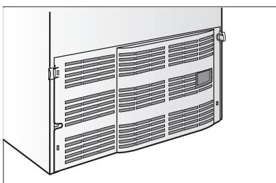
⚠ 不要覆盖或堵塞冰箱背部的压缩机挡板上的通风格栅。
