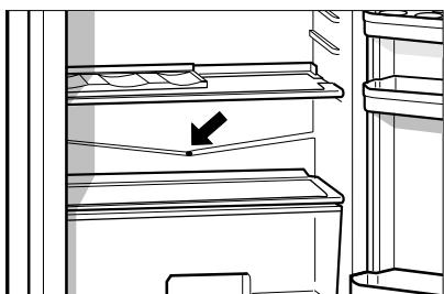
冷藏室可自动除霜，化霜水通过背部下端接水槽再由出水孔流出至冰箱后部的接水盘，并利用压缩机热量自然蒸发。
