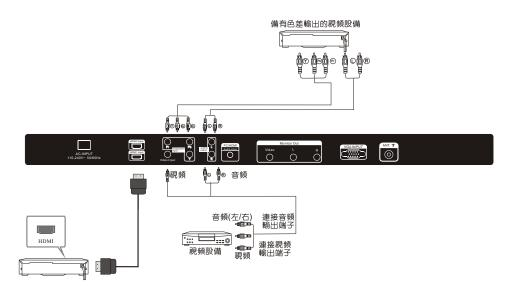
這些端子可以連接以下設備: 錄影機, 多碟式播放機, DVD影碟機, 攝錄機,遊戲機或立體聲音響設備等。 色差端子可以兼容以下視頻格式: 480i, 480p, 576i, 576p, 720p/50Hz, 720p/60Hz, 1080i/50Hz, 1080i/60Hz, 1080p/24Hz, 1080p/50Hz, 1080p/60Hz.
