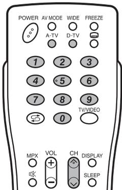
**A-TV ( 模擬電視 )**：按該按鈕切換到模擬電視模式。從數碼電視或外部輸入模式切換到模擬電視模式之後，頻道會切換至最近觀看過的模擬電視頻道。
