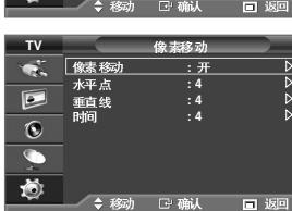
◆ **像素移动**: 使用此功能，可以按照设定的时间在水平或垂直方向移动 PDP 上的像素一次，以防止屏幕残影。
