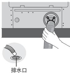
3. 按下连接环并将其推入排水口，以确保两者牢固相连。
