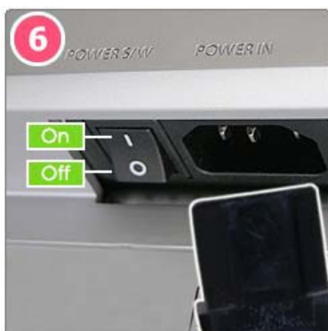
POWER S/W : 开关显示器
