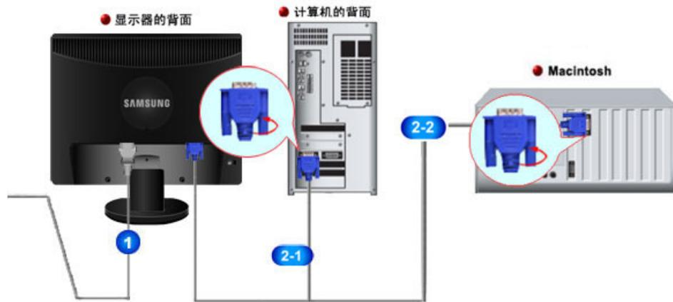
**1** 将显示器的电源线连接到显示器背面的 power 端口。
