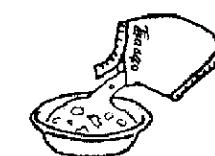
用袋子密封的食品，加熱時可能會使袋子炸裂，所以務必剝出來，裝在其他容器內加熱。又鋁箔包裹食品之鋁箔會反射微波而無法加熱，故一定要打開剝出來。
