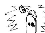
如牛奶瓶類瓶口較小者，加熱時瓶內液體可能會噴出；故最好先行倒入大碗之類開口較大的容器內，再行加熱。
