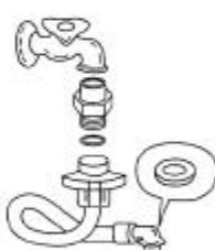
3. 將進水管接頭連接至洗衣機進水口並將之旋緊。
