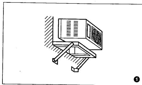
② 固定安裝架時，請如圖調整。室內側請如圖所示離牆 90mm，以利規格表查詢。
