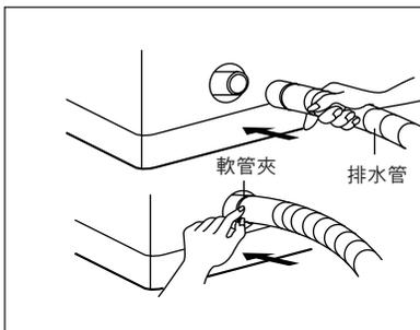
• 機體後有一排水管出口,請將排水管裝上,並用軟管夾夾緊
