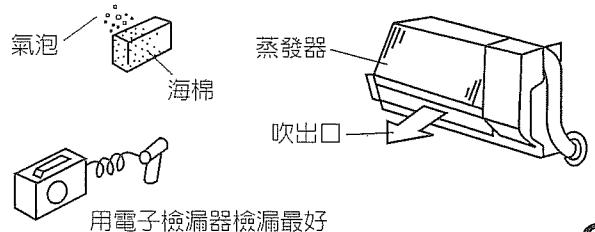
④ 檢查蒸發器滴排水情形，尤其在排水管接頭處不得漏水。
