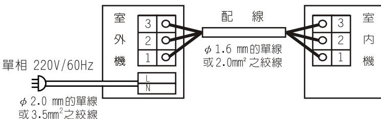
**④** 請務必選用冷氣機專用的電源回路。
