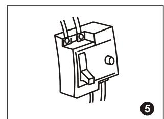
**⑥** 在配線接觸不良下連續運轉，將導致過熱、發生火災或起動運轉不良。
