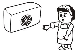
③ 5~10分鐘後，檢查蒸發器之冷卻情形及冷風吹出狀況(室內外機接頭部份務必檢漏)。
