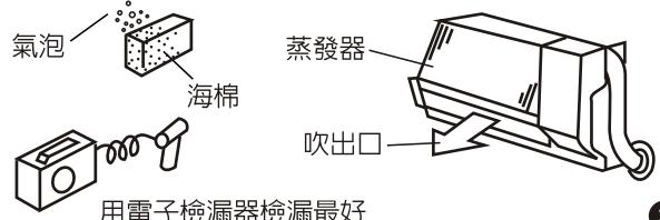
④ 檢查蒸發器滴排水情形，尤其在排水管接頭處不得漏水。
