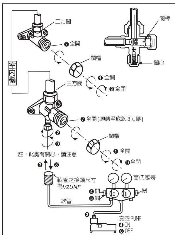
**!** 注意 真空 PUMP 須裝有逆止閥，以防 PUMP 潤滑油逆流至高低壓表內。
