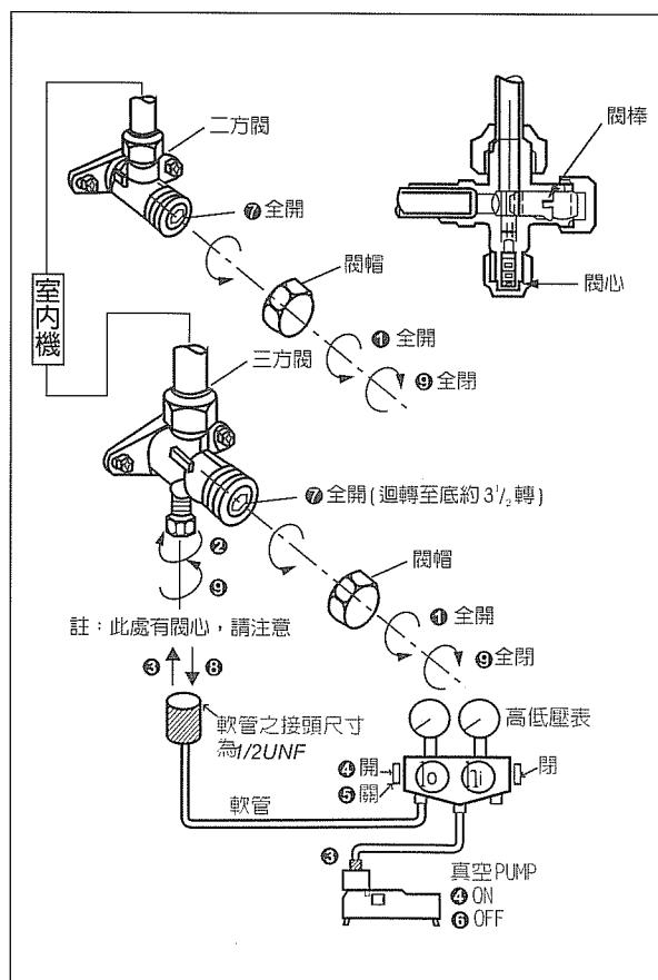
**!** **注意** 真空PUMP須裝有逆止閥，以防PUMP潤滑油逆流至高低壓表內。
