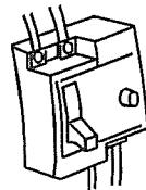
在配線接觸不良下連續運轉，將導致過熱、發生火災或起動運轉不良。
