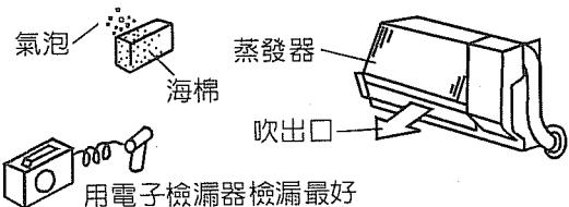
④ 檢查蒸發器滴排水情形，尤其在排水管接頭處不得漏水。
