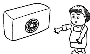
③ 5~10分鐘後，檢查蒸發器之冷卻情形及冷風吹出狀況（室內外機接頭部份務必檢漏）。
