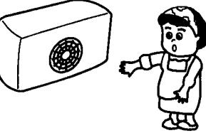
③ 5~10分鐘後，檢查蒸發器之冷卻情形及冷風吹出狀況（室內外機接頭部份務必檢漏）。
