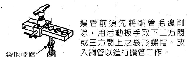
擴管前須先將銅管毛邊削除，用活動扳手取下二方閥或三方閥上之袋形螺帽，放入銅管以進行擴管工作。
