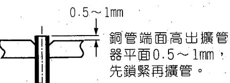
表面光滑，圓周高度相同。若擴管偏斜或破裂，異物嵌上，須以切管刀切斷，重新擴管。
