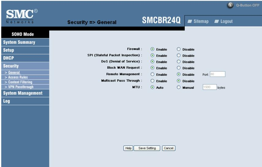
**Firewall 防火墙：**默认情况下是启用的。如果用户禁用了防火墙功能，那么 SPI, DoS, 阻止来自 WAN 请求这些功能也将被禁用。远程管理将被启用以及访问规则和 content 过滤将被禁用。
