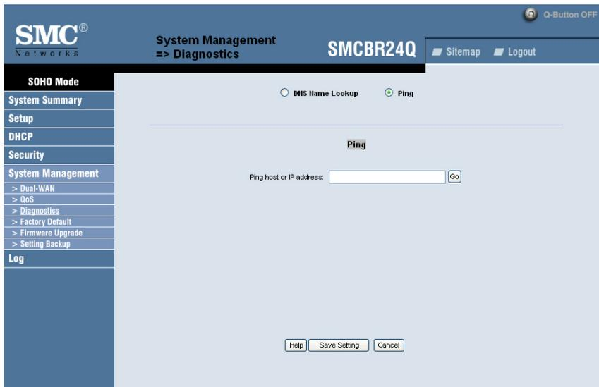
**Ping** 测试是检验 SMCBR24Q 是否可以被远程主机联系到的方法。如果局域网中的用户无法访问 Internet 上的服务，可以试着 ping DNS 服务器，或者在 ISP 上的其他机器。如果这项测试成功了，试着 ping ISP 以外的设备。这将检测到网络的无法访问是否是由于 ISP 造成的。
