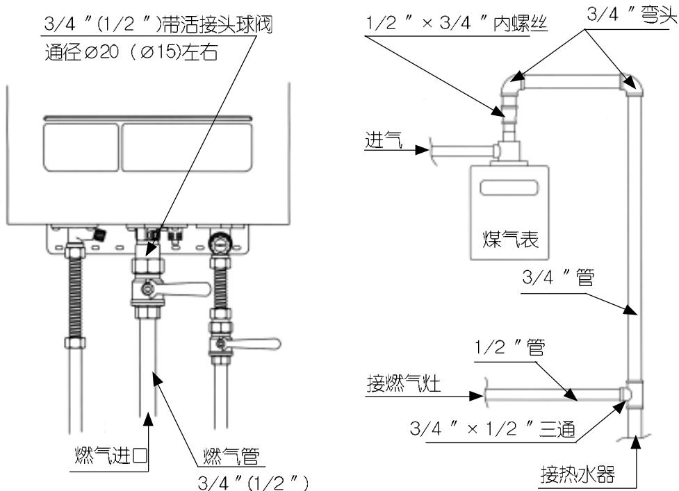
注：括号内的尺寸为液化气和天然气热水器安装规格
