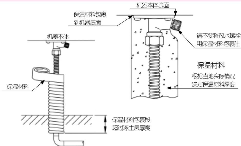
注：在寒冷地区，建议在配管上先进行电加热防冻设置后再包裹保温材料。
