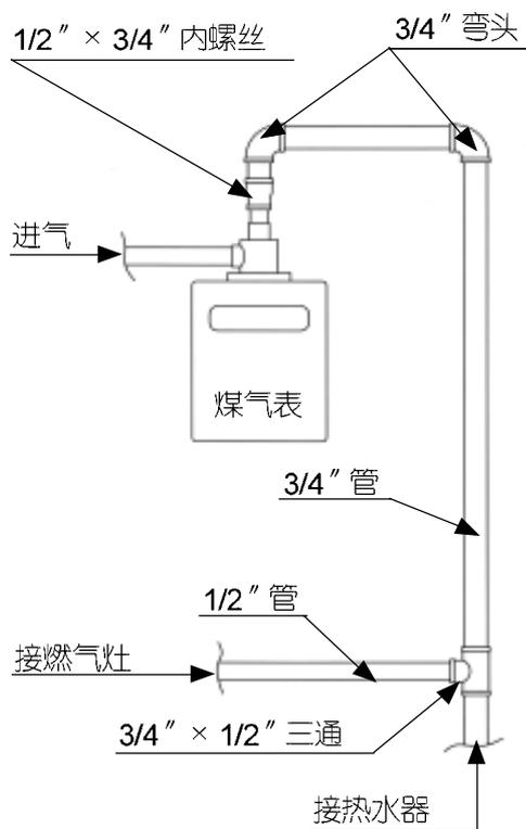
注: 括号内的尺寸为液化气和天然气热水器安装规格
