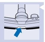
▶ 吸尘嘴正面的开口允许吸取体积较大的灰尘微粒。
