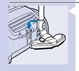
■ 将吸尘嘴上的夹片插入插槽中,您可以将硬管放置妥当。
