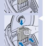
4 将集尘袋固定架和集尘袋放回吸尘器。
