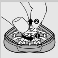
**4** 将旧刀头取下，在剃须刀上装上新刀头。其方法如下：将有小孔的一面对准剃须刀的中心。
