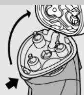
**1** Matikan alat cukur, cabut steker listrik dari stopkontak dan lepaskan steker alat dari pencukur.
