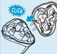
► 如刮胡刀刀头主件从刮胡刀上脱落,请检查铰链弹簧是否仍联在一起。比如铰链弹簧是否变松或是是否有裂缝或损坏。如果铰链弹簧完好,那么刮胡刀刀头主件会很容易被重新装上。但如果铰链弹簧变松,有裂缝或破损,请跟飞利浦家庭小电器维修服务中心联系,以免您的刮胡刀进一步受损。
